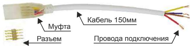
Используется для гибкого соединения двух лент, прохода отверстия и т.п., а также чтобы подключить к одному контроллеру параллельно несколько отрезков лент.
