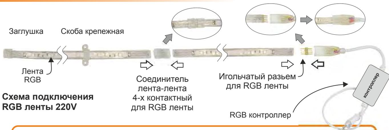
**Схема подключения RGB ленты 220V**
